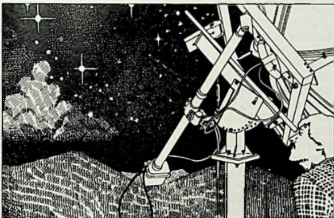
Afb. 12 Deze tekening toont de afregeling op de poolster bij avond of nacht.
